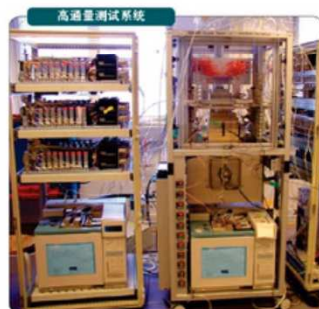
图1. 该设施由UOP和SINTEF开发，有48个反应器测试48个样品。
